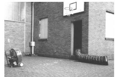
Abbildung 21: Druckbelüftung und gleichzeitige Abführung der Brandgase
