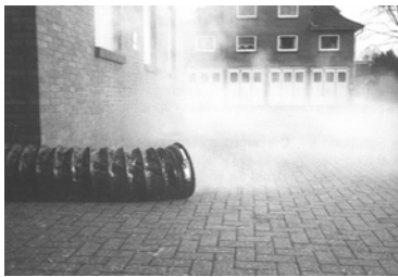
Abbildung 20: Druckbelüftung und gleichzeitige Abführung der Brandgase
