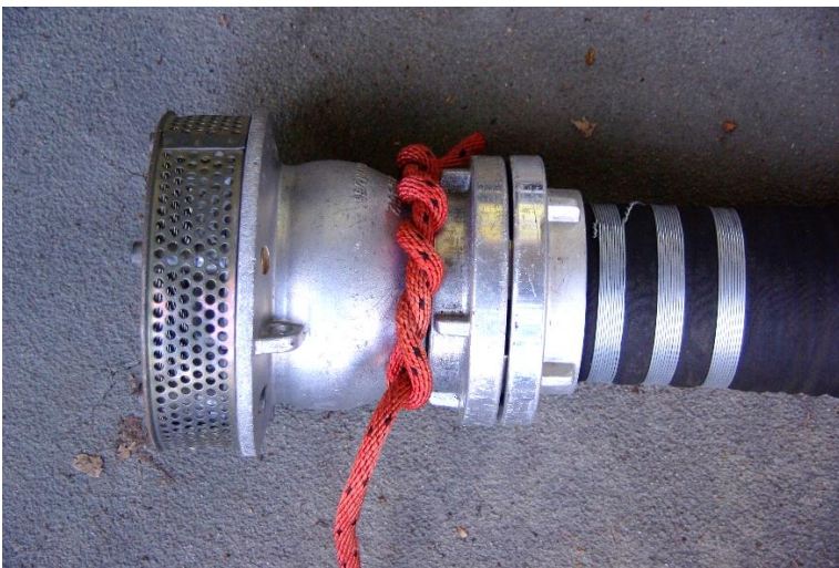
Abbildung 45: Zimmermannsschlag an einer Saugleitung
