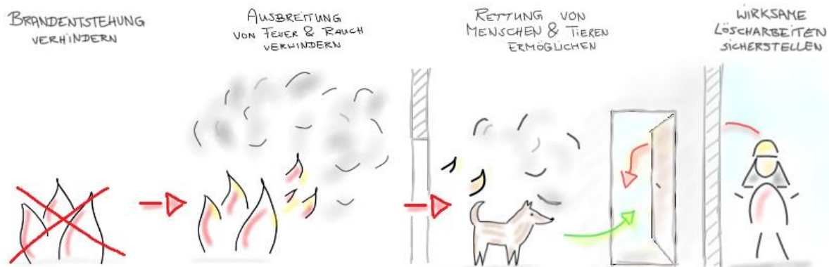
Abbildung 2 Schutzziele des vorbeugenden Brandschutzes
