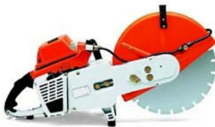
Auf Grund der hohen Umfangsgeschwindigkeit der Trennscheibe und der großen Reibung, wird bei Betrieb des Trennschleifers ein starker Funkenflug verursacht. Die entstehenden Funken können eine Temperatur von bis zu 1.800 °C erreichen. Zusätzlich werden durch den Materialabtrag an dem zu bearbeitenden Werkstück, aber auch durch den Abrieb (Verschleiß) der Trennscheibe, kleinste Teilchen mit großer Geschwindigkeit weggeschleudert.
