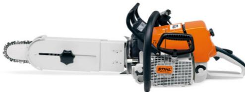
Die Rettungssäge ist eine tragbare Motorsäge mit Verbrennungsmotor und Spezialkette, bei denen die Schneidezähne eine Aufpanzerung aus schlagzähem Hartmetallplatten besitzen. Sie eignet sich zum Trennen von Verbundwerkstoffen wie z.B. Sandwichplatten, Bleche, Wärmedämmung, Verbundglasscheiben, Dachpappe, Holz-
