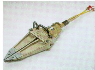
Spreizer (**SP**) sind in unterschiedliche Typen eingeteilt. Ihre Spreizkraft wird in Kilonewton (kN) angegeben. Die Spreizweite der Spreizerspitzen liegt zwischen 600 und ca. 800 mm. Das Gesamtgewicht des betriebsbereiten Spreizers darf maximal 35 kg betragen.
