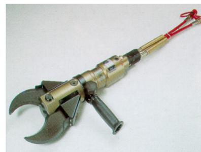
Mit den Schneidgeräten (außer sogenannten Pedalschneidern) dürfen aber **keine** Lenksäulen, Spurstangen, Stoßdämpfer, hochfeste Stoßstangenhalterungen und ähnliche Teile getrennt werden. Auch das Schneiden von Scharnieren ist möglichst zu vermeiden, da z.B. Scharnierbolzen aus gehärtetem Stahl zum Messerschaden führen kann. Es dürfen keine Teile mit freien Enden durchtrennt werden, da die Gefahr besteht, dass durch wegfliegende Teile Personen verletzt werden können.
