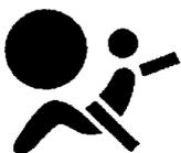
Fahrzeuge die mit Airbag ausgerüstet sind, sind mit dem Schriftzug: **SRS**, **SRS Airbag**, oder **Airbag** auf dem Airbagmodul gekennzeichnet. Sie können aber auch durch Piktogramme am Lenkrad, am Armaturenbrett oder an den Fahrzeugscheiben gekennzeichnet sein. Die Seitenairbags sind auf den Außenseiten der Türverkleidungen bzw. der Rückenlehnen gekennzeichnet.
