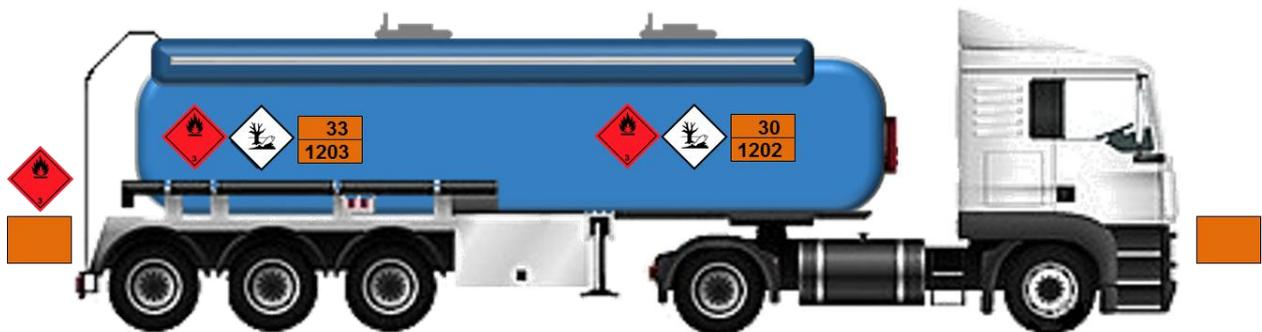
Abbildung 17: Mehrkammerfahrzeug
