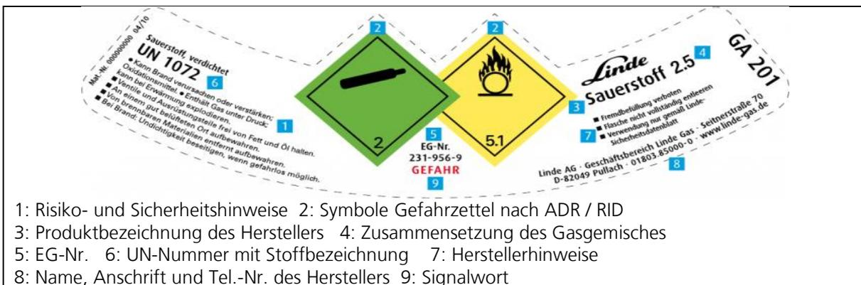
Abbildung 14: Bezettelung für Druckgasflaschen
