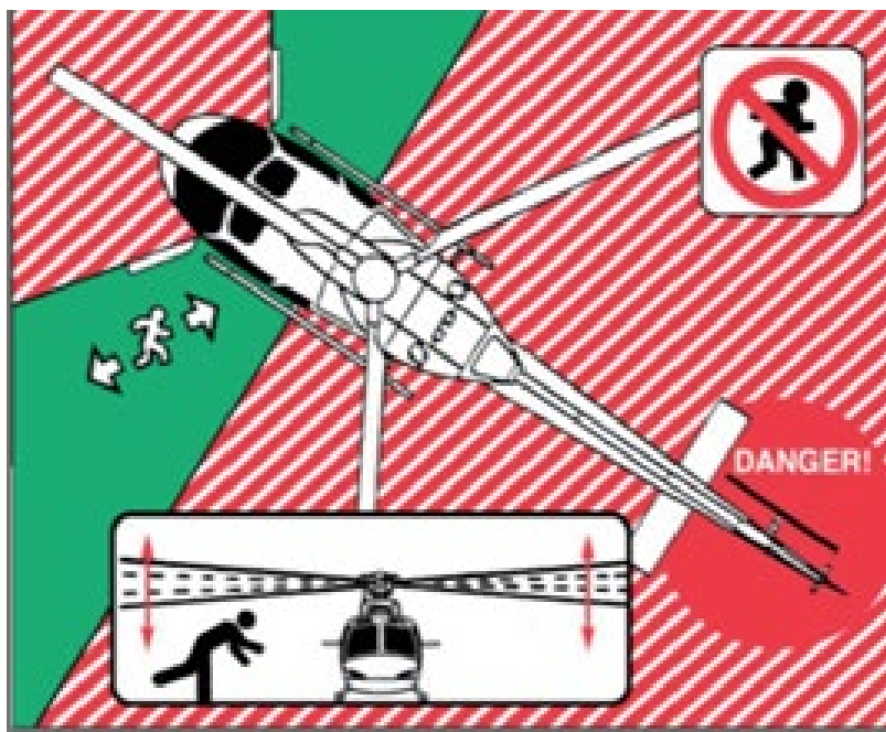
Abbildung 8: allgemeine Gefahrenbereiche eines Hubschraubers (Quelle: CALSTAR Helicopter Safety for First Responders)
