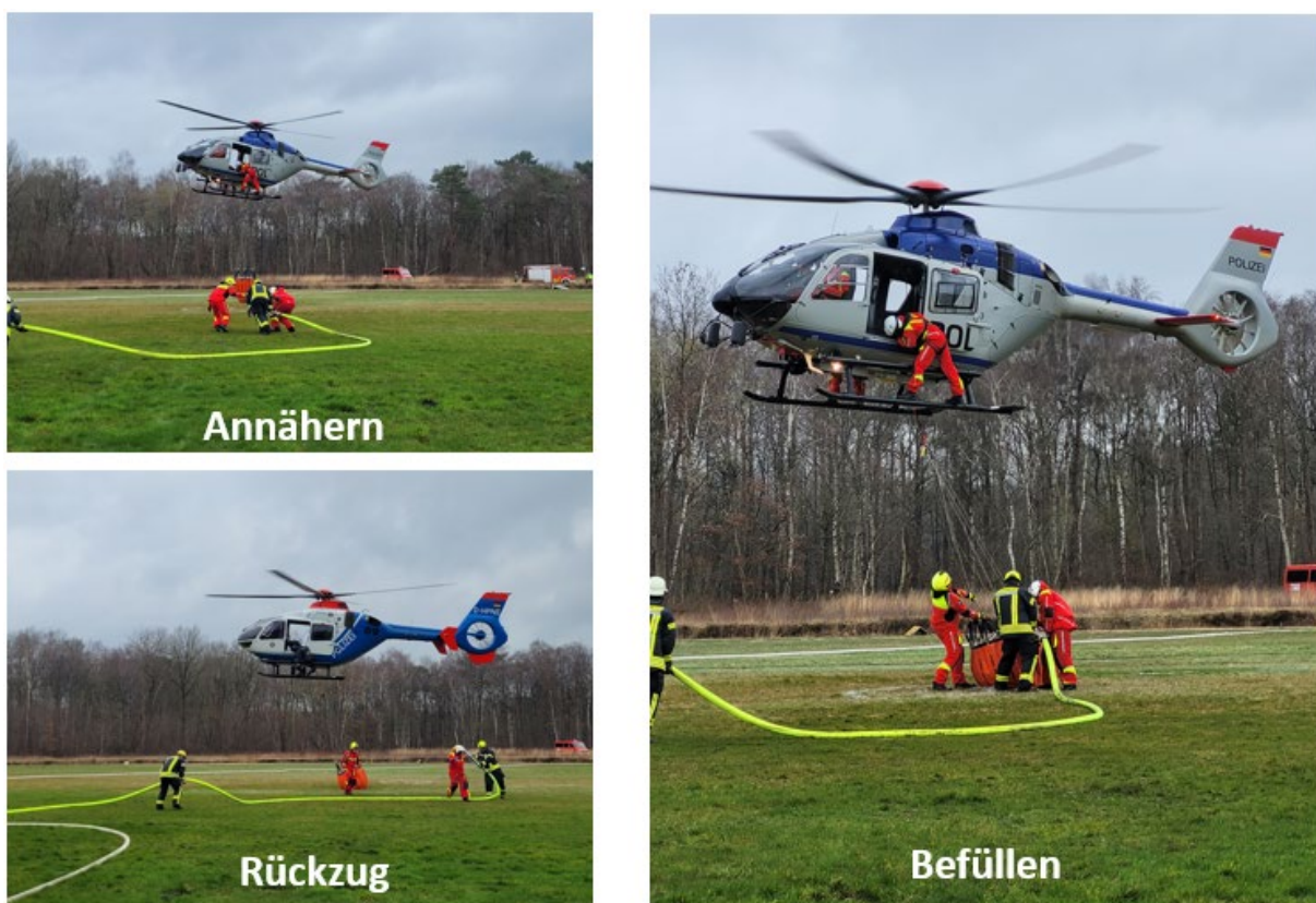
Abbildung 13: Befüllvorgang mittels Füllrohr unter schwebendem Hubschrauber (Quelle: NLBK)
