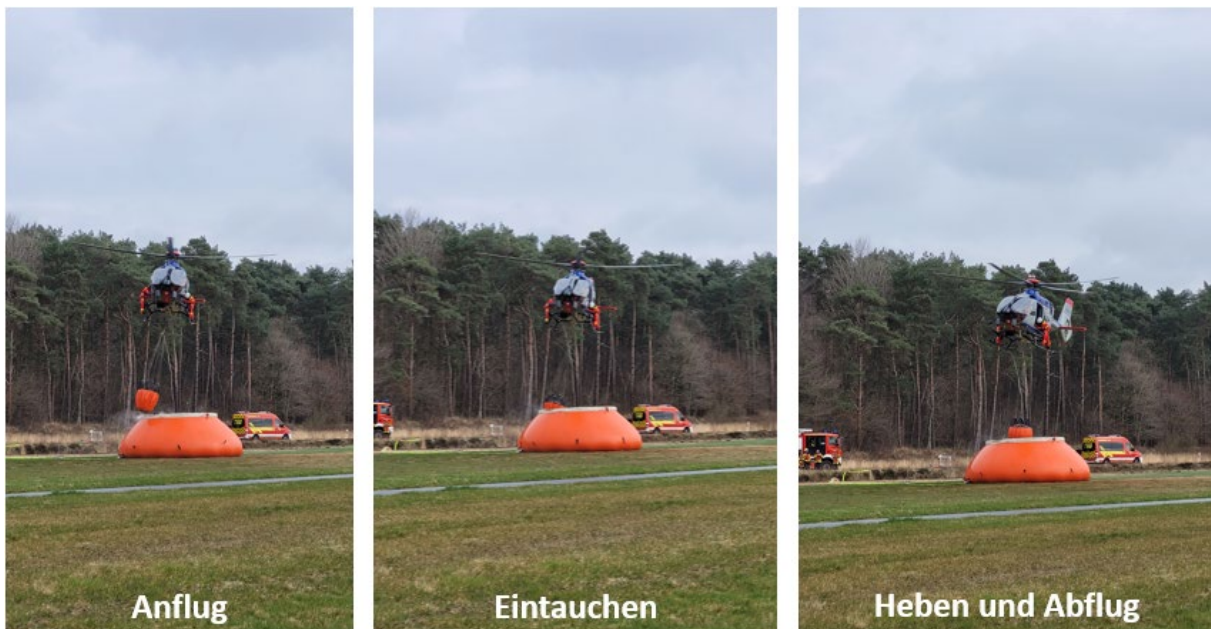
Abbildung 12: Wasserentnahme aus einem 36m³ Faltbehälter (Quelle: NLBK)
