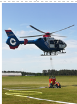
Schlauchbefüllung Bambi-Bucket mit Flughilfspersonal
