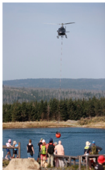
Befüllung offenes Gewässer
